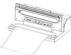
Coloque un extremo de la bolsa sobre la barra de sellado, pero no en la cámara de sellado.
