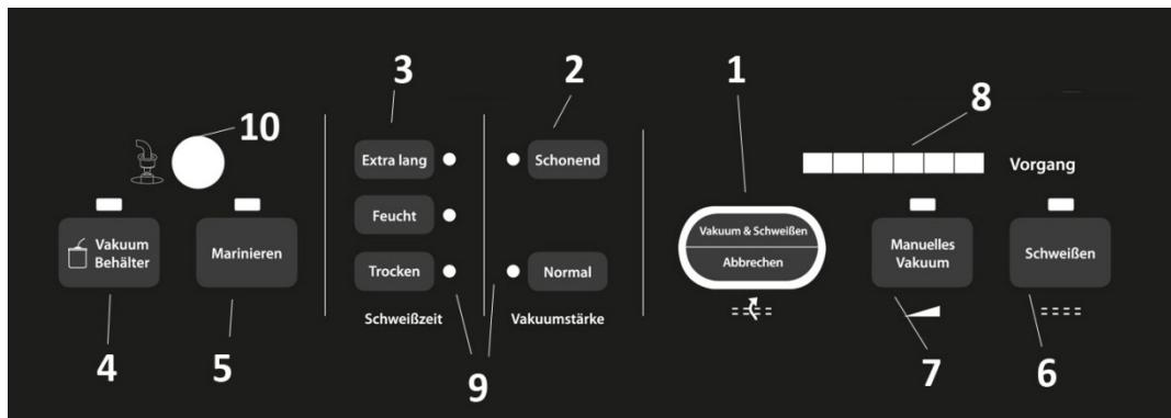
**1 Vacío y sellado/Interrumpir (Vakuum&Schweißen/Abbrechen):** Este botón tiene dos funciones, dependiendo del estado del aparato.
