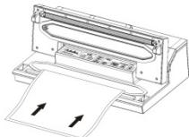
Controleer dat beide kanten van het open uiteinde van het zakje zich in de vacuümruimte bevinden. Dit garandeert dat er geen vacuüm ontsnapt.
