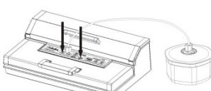
Cierre la tapa y presione firmemente hacia abajo el mango delantero.
