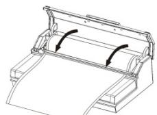
Controleer dat de cutter zich aan het uiteinde van de cutterrails bevindt. Druk dan de cutterrails weer naar achteren.
