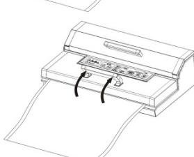
Druk de voorste handgreep weer naar boven, open het deksel en verwijder het zakje. Het zakje kan nu worden gebruikt voor het vacumeren.
