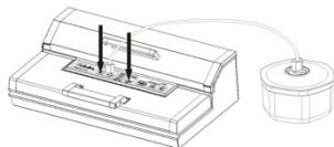
Controleer de LED-toestandsindicator voor de vacuümsterkte; die moet op „normaal“ (normal) staan.
