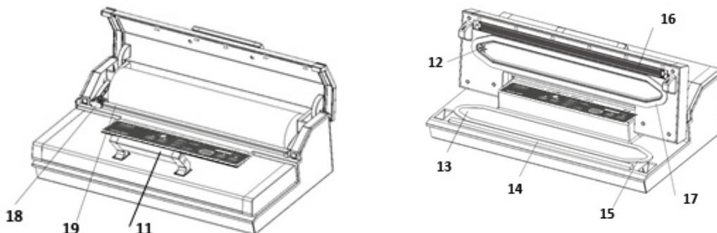
**11 Manico anteriore:** Spingerlo in basso per chiudere la copertura. Sollevarlo per aprire la copertura.
