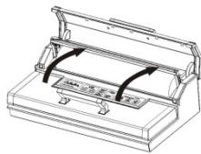
Sluit het apparaat aan het stroomnet aan en plaats de hoofdschakelaar (deze bevindt zich aan de achterkant van het apparaat) op „I“.
