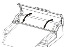
Legen Sie ein Ende des Beutels über den Schweißbalken aber nicht in die Vakuumkammer.
