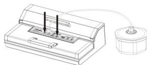
Premere il pulsante „Marinare“ (Marinieren). L'indicatore di avanzamento a LED è acceso durante l'operazione. Viene estratta aria e dopo la messa sotto vuoto automaticamente fatta rientrare. Dopo tre minuti di pausa inizia daccapo il ciclo di lavoro. La procedura si esegue per 5 cicli di lavoro.
