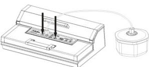
Cuando la indicación de proceso se apaga, el proceso de marinado ha finalizado. Retire el tubo flexible de vacío de la conexión de la tapa del recipiente y del aparato.
