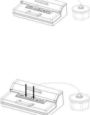
Druk op „Marineren“ (Marinieren). De LED-staatindicator G licht tijdens het proces op. De lucht die wordt afgezogen wordt na het vacumeerproces automatisch weer aangevuld. Na drie minuten pauze begint de cyclus opnieuw. Het proces heeft in totaal 5 cycli.
