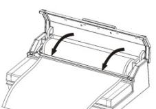
Enrolle la lámina hasta la longitud que desee y córtela hasta la longitud deseada mediante un corte preciso y limpio.
