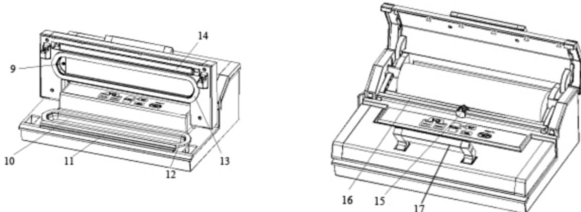
**9 Aspiration de l'air :** Entrée d'air liée à la chambre à vide et pompe. Ne couvrir pas cette entrée d'air durant le procédé de la mise sous vide et le soudage d'un sachet.
