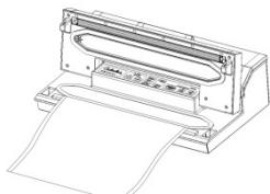
Mettere un'estremità del sacchetto sopra la barra di saldatura, ma non nella camera del vuoto.
