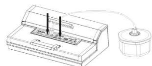
Drücken Sie „Vakuumbehälter“. Drücken Sie am Anfang des Vakuumiervorgangs den Deckel fest an, um zu verhindern, dass Luft entweichen kann.
