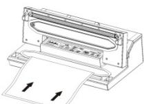
Reinigen und glätten Sie das offene Ende des Beutels und vergewissern Sie sich, dass keine Falten und keine Wellen auf den Flächen des offenen Endes sind.
