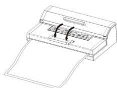
Premere "Sotto vuoto e saldatura" (Vakuum&Schweißen). L'indicatore di stato a LED E si accende e automaticamente viene aspirata aria e il sacchetto poi sigillato. Questo scompare quando il processo è completo.
