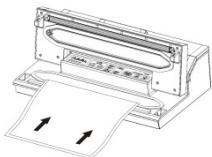
Cierre la tapa y presione firmemente hacia abajo el mango delantero.
