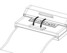
Cierre la tapa y presione firmemente hacia abajo el mango delantero.
