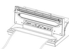
Coloque un extremo de la bolsa sobre la barra de sellado, pero no en la cámara de sellado.
