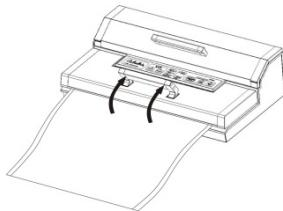
Suba el asa delantera nuevamente hacia arriba, abra la tapa y retire la bolsa. Ésta puede utilizarse ya para envasar al vacío.
