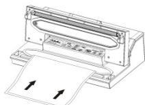
Controleer dat beide kanten van het open uiteinde van het zakje zich in de vacuümruimte bevinden. Dit garandeert dat er geen vacuüm ontsnapt.
