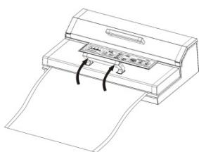
Druk op de kop „handmatig lassen”. De LED-staatindicator D licht op en. Dit verdwijnt wanneer het proces is voltooid.
