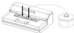
Fije un extremo del tubo flexible de vacío a la conexión del aparato y otro extremo a la conexión de la tapa del recipiente.
