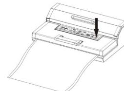
Pressez le bouton „Manuelles Schweißen“ (le soudache manuel). Les LED (D) s'allume. Celle-ci disparaît lorsque le processus est terminé.
