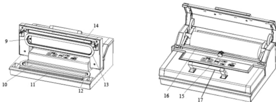
**9 Aspiración de aire:** Entrada de aire conectada con la cámara de vacío y la bomba. Tape la entrada de aire durante el proceso de vacío y no selle una bolsa.
