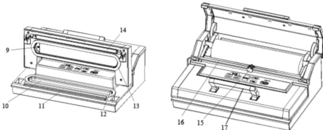
**9 Luftansaugung:** Lufteinlass verbunden mit Vakuumkammer und Pumpe. Decken Sie diesen Lufteinlass beim Vakuumieren und Verschweißen eines Beutels nicht ab.
