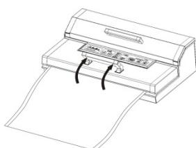
Drücken Sie den vorderen Griff wieder nach oben, öffnen Sie den Deckel und entnehmen Sie den Beutel. Dieser kann nun zum Vakuumieren benutzt werden.
