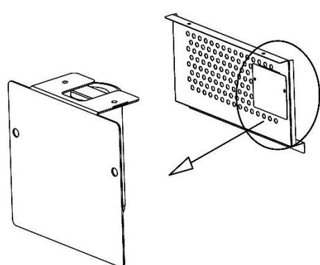
Abdeckung entfernen. An dieser ist die UV-Lampe befestigt.
