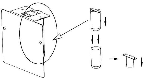
Retirez le couvercle de la lampe UV et remplacez la lampe.
