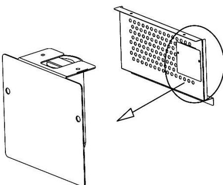
Afdekking verwijderen. De UV-lamp is hieraan bevestigd.
