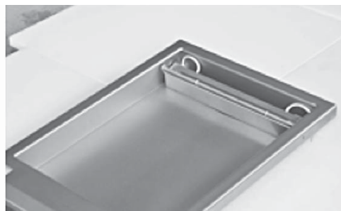
12. Die Leitung des kompletten Dichtungsbandes an den Bolzen anschließen und danach das Dichtungsband erneut in der Unterdruckkammer unterbringen, um die Installation zu beenden.
